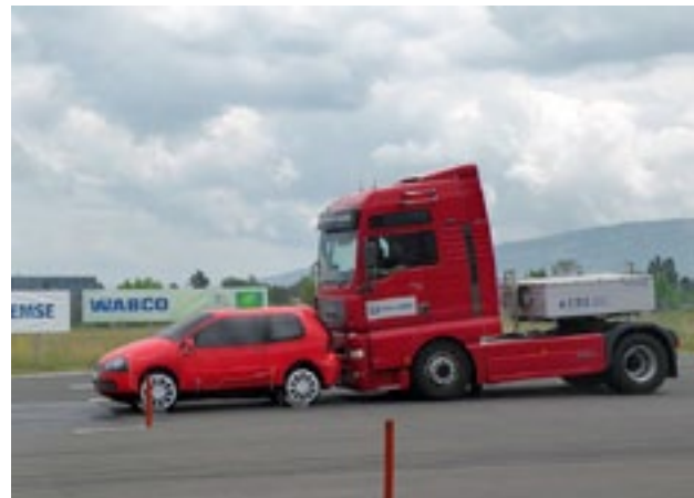
1. ÁBRA: Gépjárművek fejlett vészfékező rendszerének (AEBS) vizsgálata: a vizsgált tehergépkocsi éppen automatikusan megáll a „cél-tárgy” előtt
