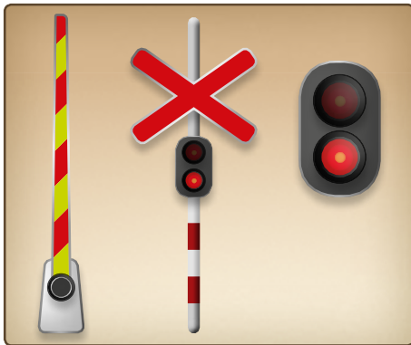
6. ábra: A norvég vasúti átjáró tartozékai
