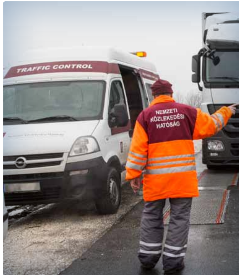
Mérés előtt a járműszerelvényt párhuzamosan beállítják a mérősorral
