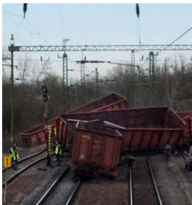
A törött biztosítólemez miatt kisiklott vagonok
