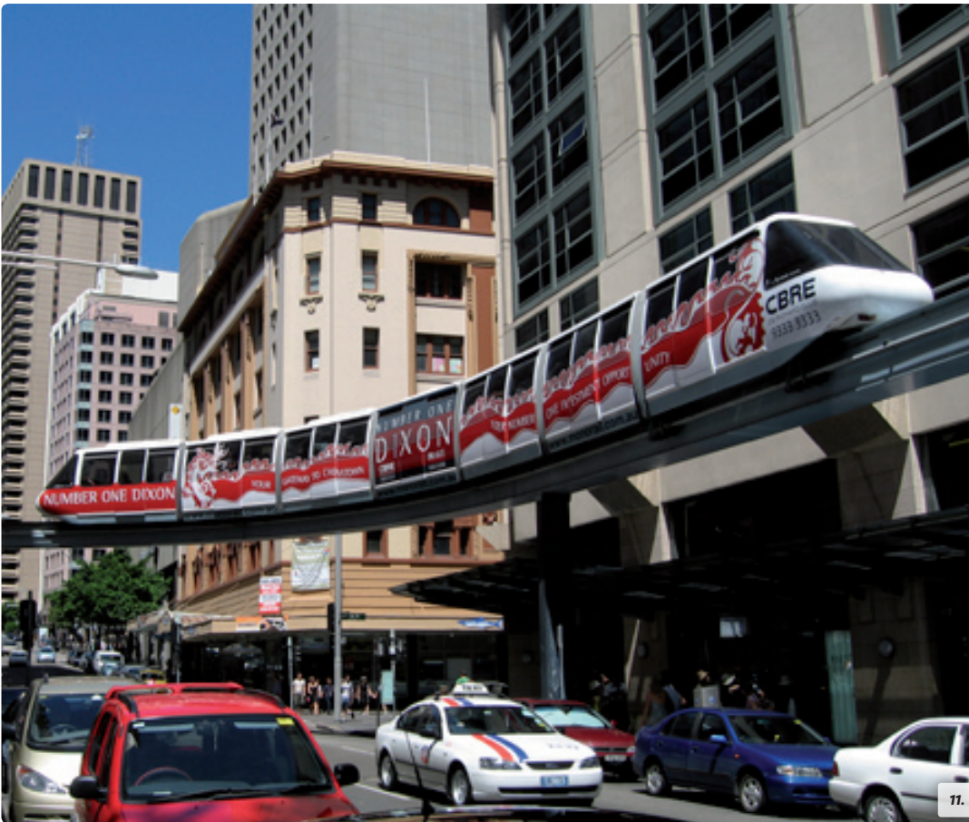
A nyeregvasút alkalmazási lehetősége szűk belvárosi utcák esetében; a sínt az épületekhez rögzítik (Sydney)
