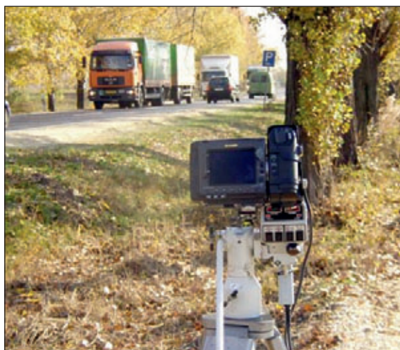
4. ábra: az osztályozási és sebességmérési pontosság ellenőrzése
