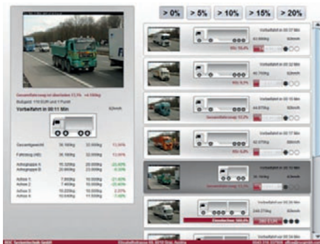
4. ábra: a tengelysúly ellenőrzés képi megjelenítése
