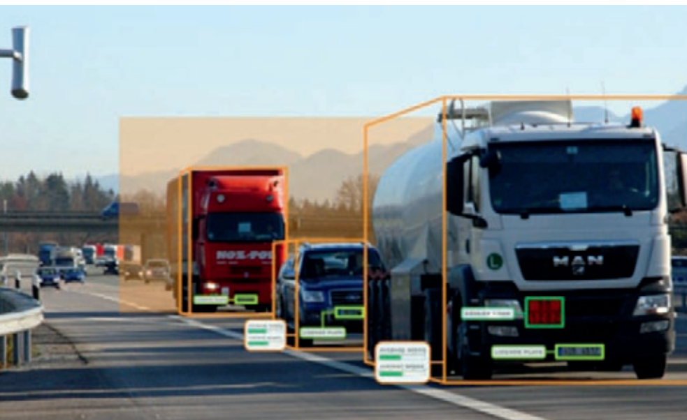
5. ábra: az ASSET-Road projekt járműazonosító rendszere
