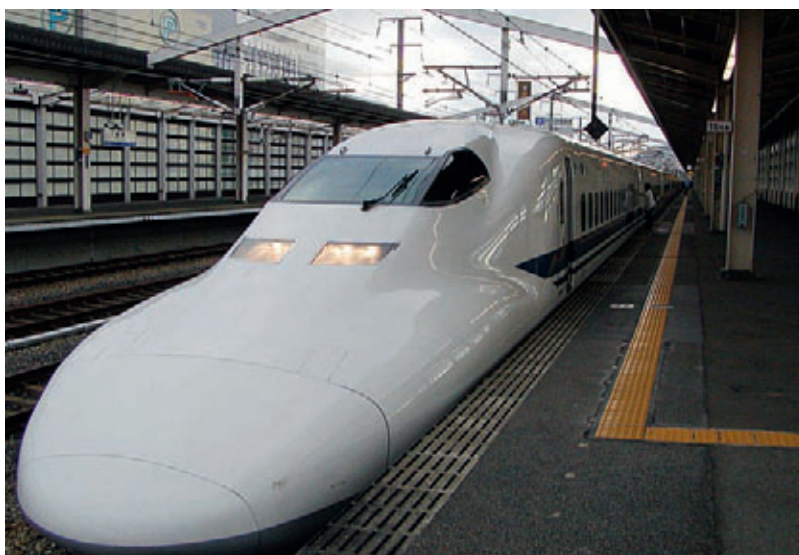
A Japán Sinkansen 700-as sorozata, 1997-től 2004-ig gyártották. Nagysebességű motorvonat tervezésénél fontos szempont az áramvonalas forma. A csőben nincs többé légellenállás
