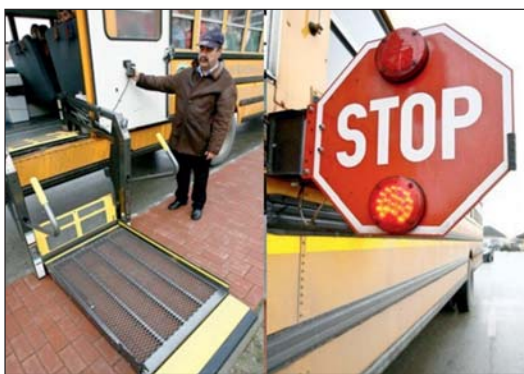
11. ábra: Gelsei iskolabusz mozgássérült-emelő lifttel és stoptáblával Forrás: www.zalaihirnap.hu
